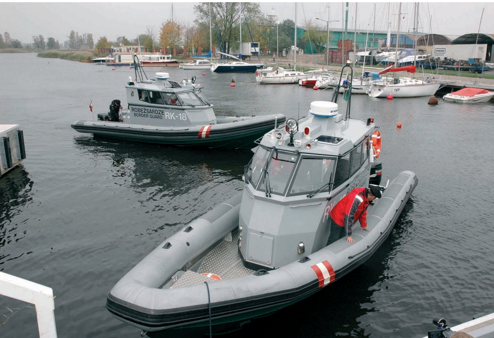
Pavisam Šengenas finanšu programmas ietvaros Somijā uzbūvēti pieci šāda “Boomeranger” tipa kuteri. To bāzēšanās ostas ir Roja, Mērsrags, Engure, Skulte, Salacgrīva. Kutera garums – 10,6 m, maksimālais ātrums – 50 mezgls. Kuteri ir aprīkoti ar diviem piekaramiem “Suzuki” firmas benzīna dzinējiem, kuru kopējā jauda ir 450 zirgspēki, kā arī ar modernām sakaru un navigācijas iekārtām. Kuteri ir ļoti stabili un manevrētspējīgi, tāpēc tie labi piemēroti patrulēšanai, kā arī glābšanas un meklēšanas operācijām.
