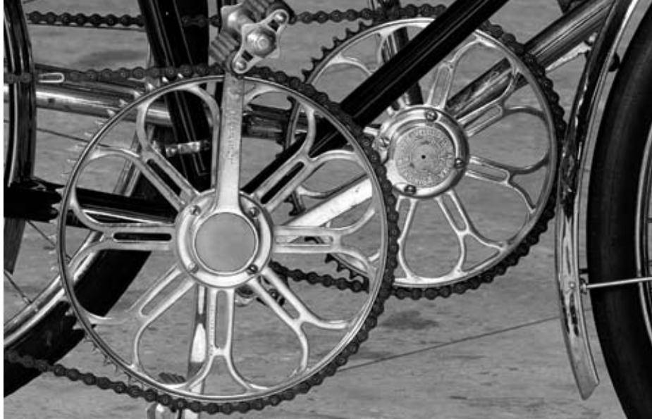
Ekspozīcijā aplūkojams arī "Ozolnieks – Grand Prix" (1935. g.). Tas izgatavots pirmajā neatkarīgās Latvijas velosipēdu fabrikā "P. Ozolnieks". Velosipēda rāmis ir niķelēts, tas ir aprīkots ar F&S "torpedo" sistēmas brivrumbu un "Union" firmas rullīšu 1/2 ķēdi. Smagnējs, bet ļoti labs un izturīgs velosipēds!
